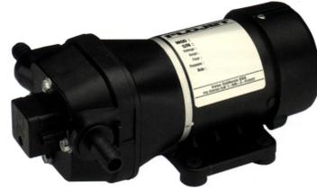
Diese Wasserversorgungspumpen werden mit Druckschalter für den automatischen Betrieb auf kleinen bzw. auch größeren Schiffen auch mit Warmwasserbereitern betrieben. Ein Saugfilter sollte unbedingt zum Schutz der Pumpe vor Verunreinigungen aus dem Wassertank installiert werden. Ein Druckausgleichstank sollte bei mehr als 2 Zapfstellen ebenfalls vorgesehen sein.
